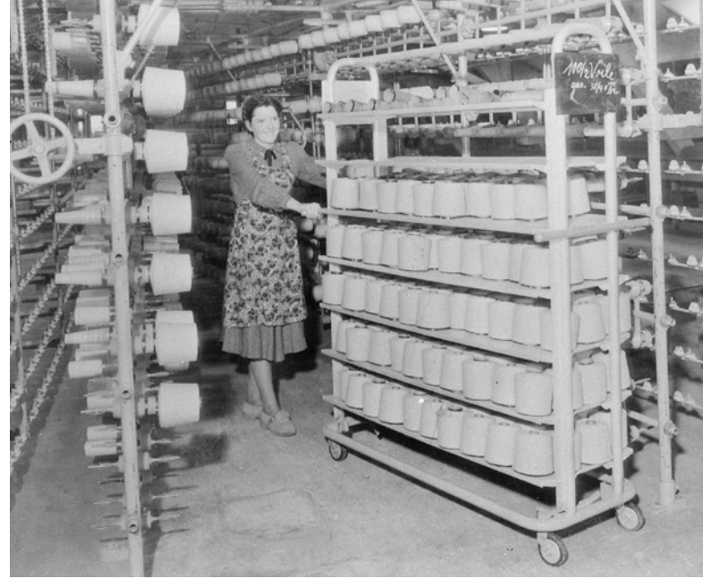
Manuelles Aufstecken von Spulen.
