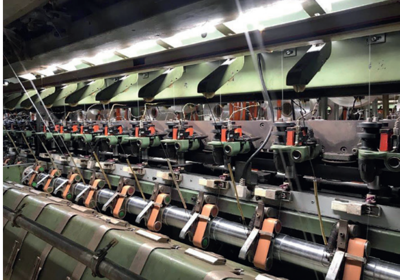
2025 Bäumlin & Ernst AG produziert unter anderem texturierte Garne mit Heberlein Texturiermaschinen FZ 27, welche mit Magnetspindeln ausgerüstet sind. Bild beag
